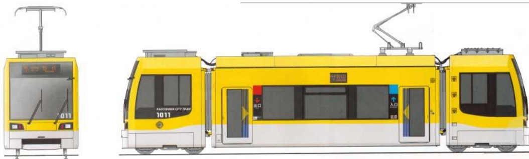
1000 形ユートラム I (3 連接 2 台車) 全長 14.0m
