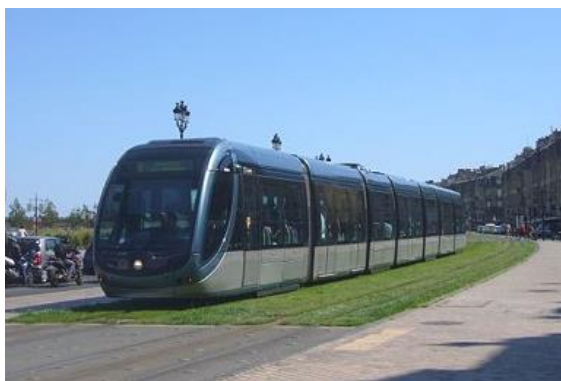
図 4-17 ボルドー(仏)の地表集電トラム
